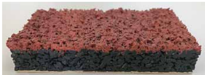
Kein Kuchen: Im Querschnitt ist die Dicke der roten Verschleißschicht der Kunststofflaufbahn gut zu erkennen.
