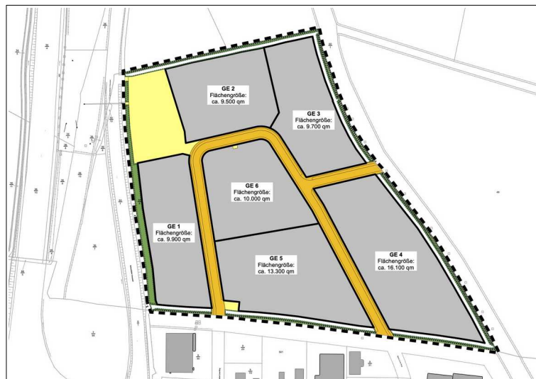
Abb.: Erschließung und geplante Parzellierung
