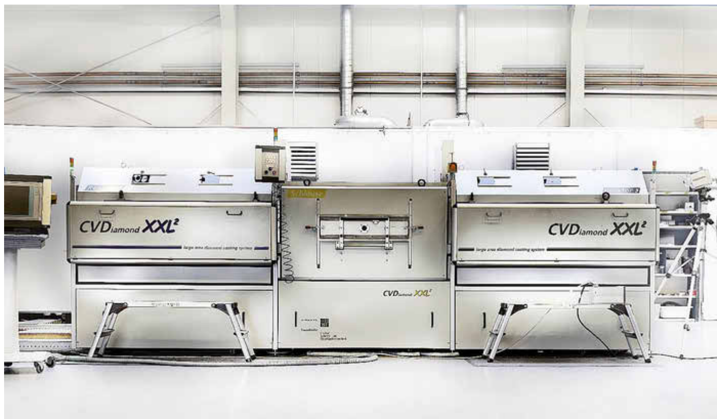
CVD-Reaktoren: In dieser Maschine entstehen bei 2200 bis 2600°C leitfähige Diamantelektroden.
