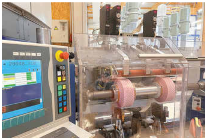
Eigene Herstellung: Die Kupferspulen für die Transformatoren werden in speziellen Maschinen gewickelt
