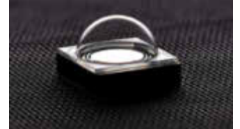
Kapsel mit Clou: Der bewegliche Spiegel ist im Vakuum unter einer Glasblase geschützt.
