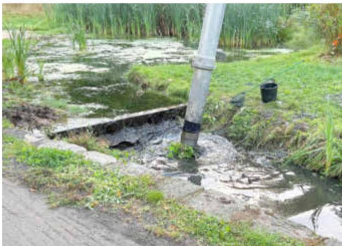
*Power-Rüssel: Die Saugkraft liegt bei einem Luftdurchsatz von bis zu 40.000 Kubikmeter pro Stunde.*
