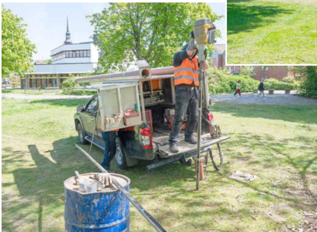
An verschiedenen Stellen wurden die halbseitig offenen Stangen in den Boden getrieben und mit der Bodenprobe wieder herausgezogen.
