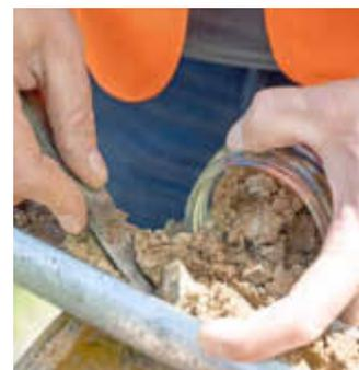
Die Bodenproben werden zur Untersuchung in Gläser abgefüllt.
