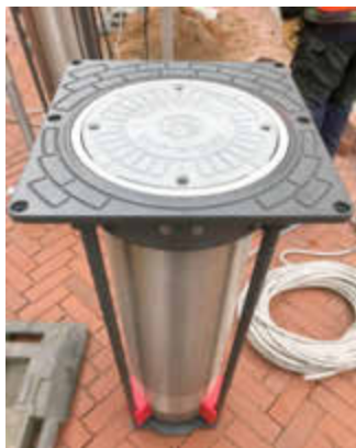
Edelstahlzylinder voller Technik: Ein 24-Volt-Motor sorgt für das hydraulische Heben und Senken des Pollers.
